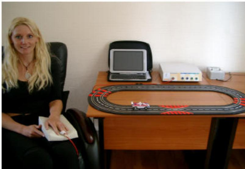
**Ein negativer Gedanke reicht aus, die Stressreaktion im Körper auszulösen. Die Biofeedback-Reaktion misst die Änderung der elektrischen Hautleitfähigkeit mit dem Finger-Sensor. Die Messkurve auf dem Bildschirm steigt. Der Motor des dadurch gesteuerten Rennautos startet, die Drehzahl steigt.**
